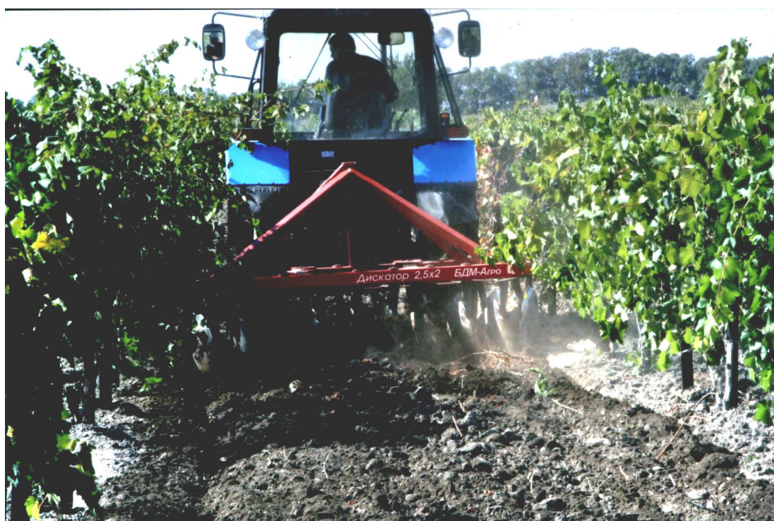
Рис. Дискатор БДМ-2,5×2 на обработке междурядий виноградника в ОПХ «Анапа»
