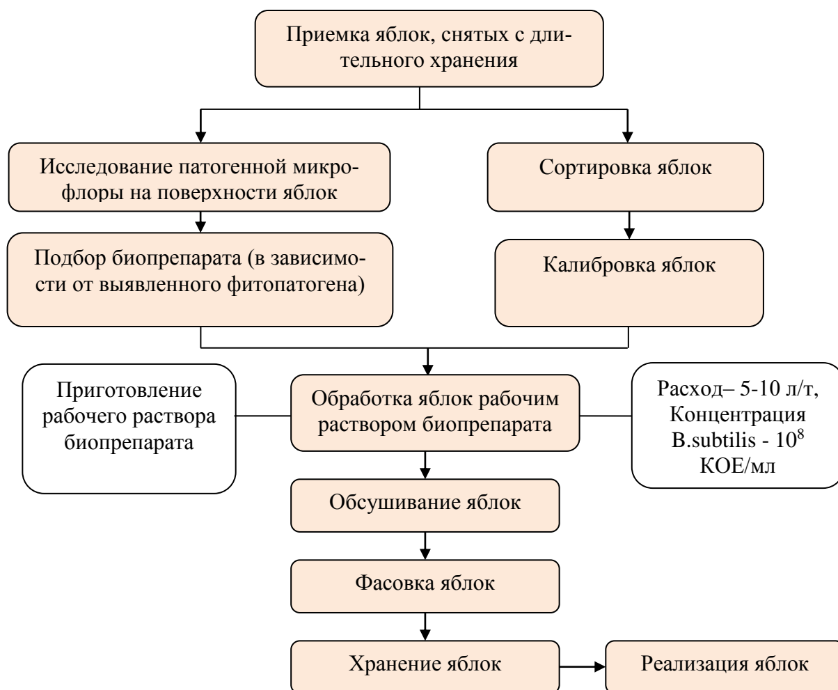
Рис. 1. Блок-схема подготовки яблок к краткосрочному хранению в условиях искусственного охлаждения.
